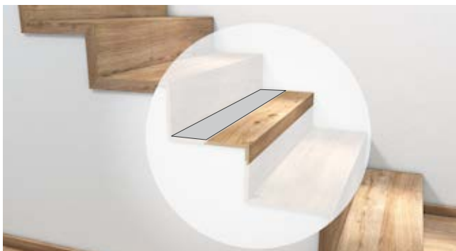
Trittstufen werden mit Bodendielen ausgeführt
