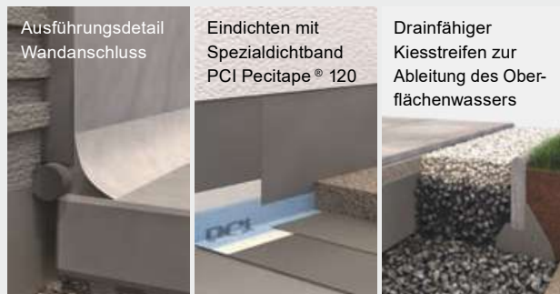
4 Ausführungsdetails Wandanschluss
