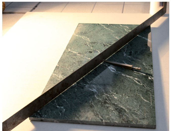
Abb. 9 – Überprüfung der Ebenflächigkeit im Lieferzustand.
