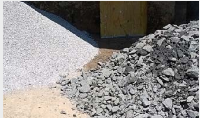
Abb. 3 – Auf geeignete Materialien für die Verwendung von Frostschutz- und Tragschicht achten – für Oberbauschichten ohne Bindemittel gilt die ATV DIN 18315.
