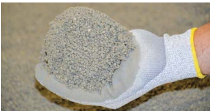
Abb. 14 – Durch eine Schneeballprobe, d. h. der Mörtel muss sich zu einem Ball formen lassen ohne dass Wasser herausläuft oder der Mörtel zerfällt, wird die Konsistenz geprüft.
